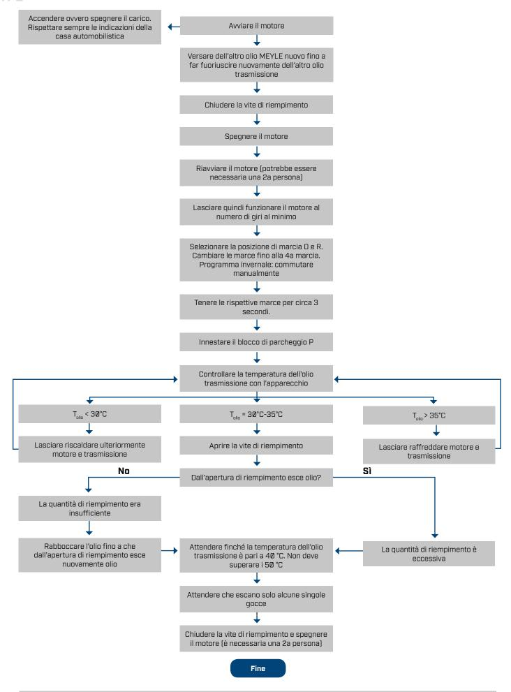
Attenzione: in diversi tipi di trasmissioni può essere montata una valvola bypass che apre o chiude il circuito dell'olio verso il radiatore dell'olio. Per questo, la temperatura dell'olio trasmissione dovrebbe raggiungere almeno una temperatura di 75°C in un giro di prova sufficiente. Dopo il giro di prova, lasciare raffreddare la trasmissione, controllare nuovamente il livello dell'olio ed eventualmente correggerlo.
